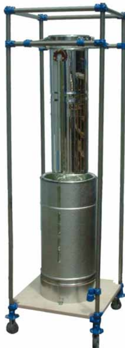
LH2 und LHe Kryostaten Kombination mit Gestell LH2 and LHe cryostat combination with rack
