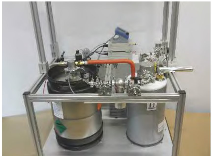
Pumpstand mit Sonder-Metallkühlfalle, Dewargefäß, automatischer LN2 Niveauregulierung und automatischer Sicherheitsabschaltung bei Vakuumbruch.
