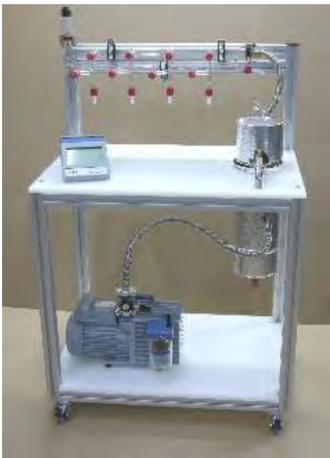
Pumpstand mit Schlenkline und GKF - Glaskühlfalle
