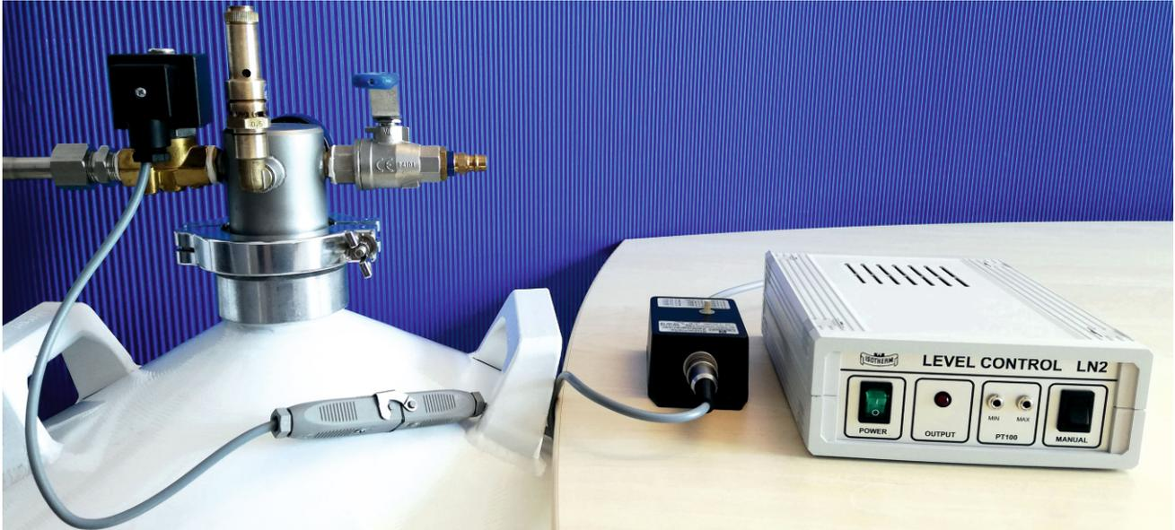
Bei vielen kryotechnischen Anwendungen, wie Schrumpfen von Wellen und Buchsen in LN2, Tiefkühlen von Bauteilen oder biologischen Proben, Einsetzen von Fühler in LN2, usw., werden automatische LN2 Niveauregelgeräte Typ „Level Control LN2“ von KGW-ISOTHERM eingesetzt.
