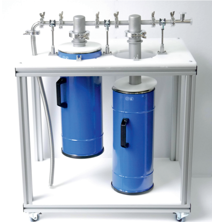
Pumpstand mit großen Metallkühlfallen und nach unten abnehmbare, große Dewargefäße
