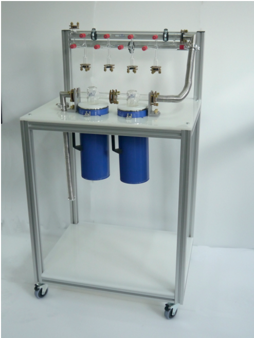
Pumpstand mit Schlenkline, Glaskühlfallen und nach unten abnehmbare Dewargefäße
