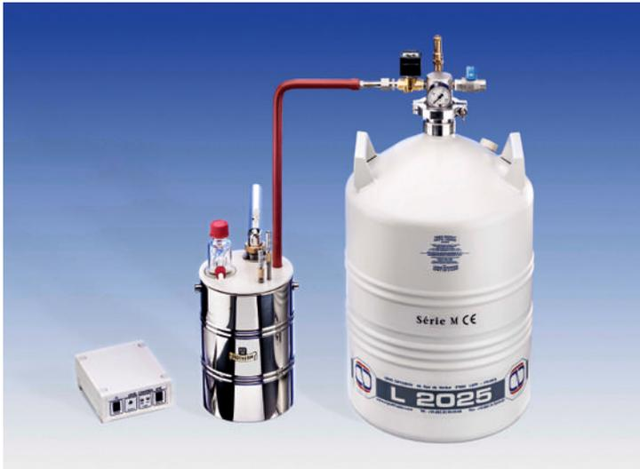
Um die Kondensationsleistung einer Kühlfalle sicher zu stellen, ist es wichtig, einen weitestgehend konstanten LN2-Flüssigkeitspegel im Dewargefäß zu halten. Durch diesen konstanten LN2 Flüssigkeitspegel wird sichergestellt, dass immer die gesamte Kondensatgefrierwand der Kühlfalle funktionsfähig ist und somit das Nutzvolumen der Kühlfalle genutzt werden kann.
